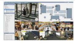
Sie können die Videostreams der BNC-Eingänge in die Videomanagement-Software GV-VMS integrieren (Lizenz erforderlich). So können Sie den DVR einsetzen, um analoge Kameras - auch in HD-Auflösung - in der Software einzubinden.
